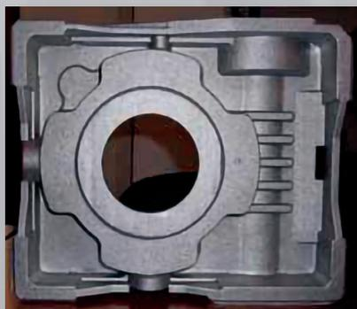
Mediante il metodo di prototipazione rapida possiamo fornire prototipi fusi, in modo da poter collaudare il prodotto prima di investire energie e risorse per la costruzione dell'attrezzatura.
